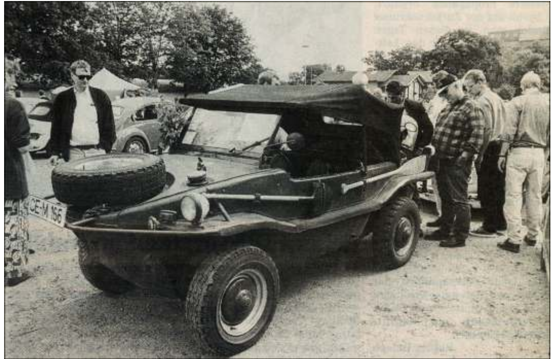
Viele neugierige Blicke zog dieser Schwimmwagen aus dem Jahre 1944 auf sich. Das wannenförmige Fahrzeug hat Allradantrieb und am Heck eine hochklappbare Schiffschraube.
